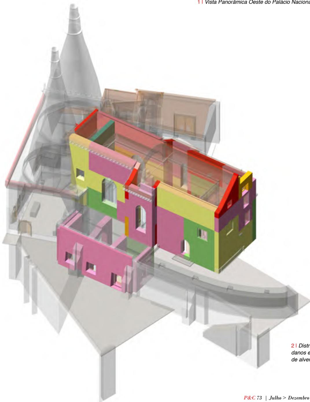
2 | Distribuição de danos em paredes de alvenaria.
