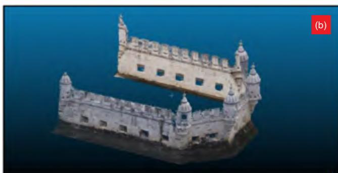
41 “Nuvens de pontos de diferentes fontes: a) de TLS; b) de fotogrametria de curto alcance; c) mesmas nuvens de pontos depois de georreferenciar a nuvem de pontos fotogramétrica.” © Redweik, P. et al (2020). Tower of Belém (Lisbon)—Status Quo 3D Documentation and Material Origin Determination. *Sensors*, 20(8), 2355. MDPI AG., disponível em <http://dx.doi.org/10.3390/s20082355>, distribuído em Open Access sob licença de Atribuição 4.0 Internacional (CC BY 4.0).
